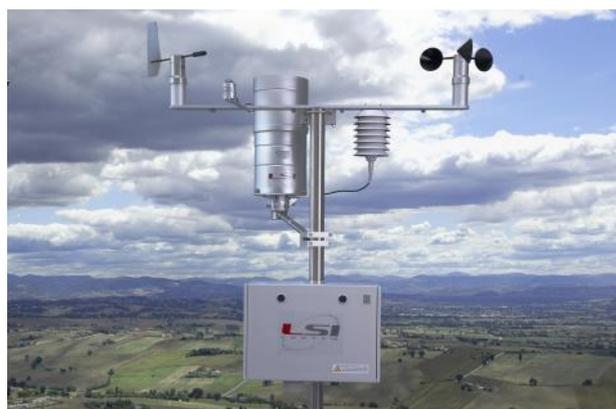
➤ DNA202.1風速センサはDYA046 連結バーを使用することでDNA212.1風向センサと一緒に取り付けることができます。同連結バーでは、温湿度センサや放射線センサのようなその他のセンサも使用可能です。
