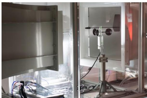
➤ LSIラステムは風速測定のISO17025認定校正機関です。製造されるすべてのセンサは当校正機関内で検証されています。LSIラステムはいかなるセンサにも試験報告を提供し、ご要望があれば、ISO17025またはISO9001校正証明書も提供いたします。
